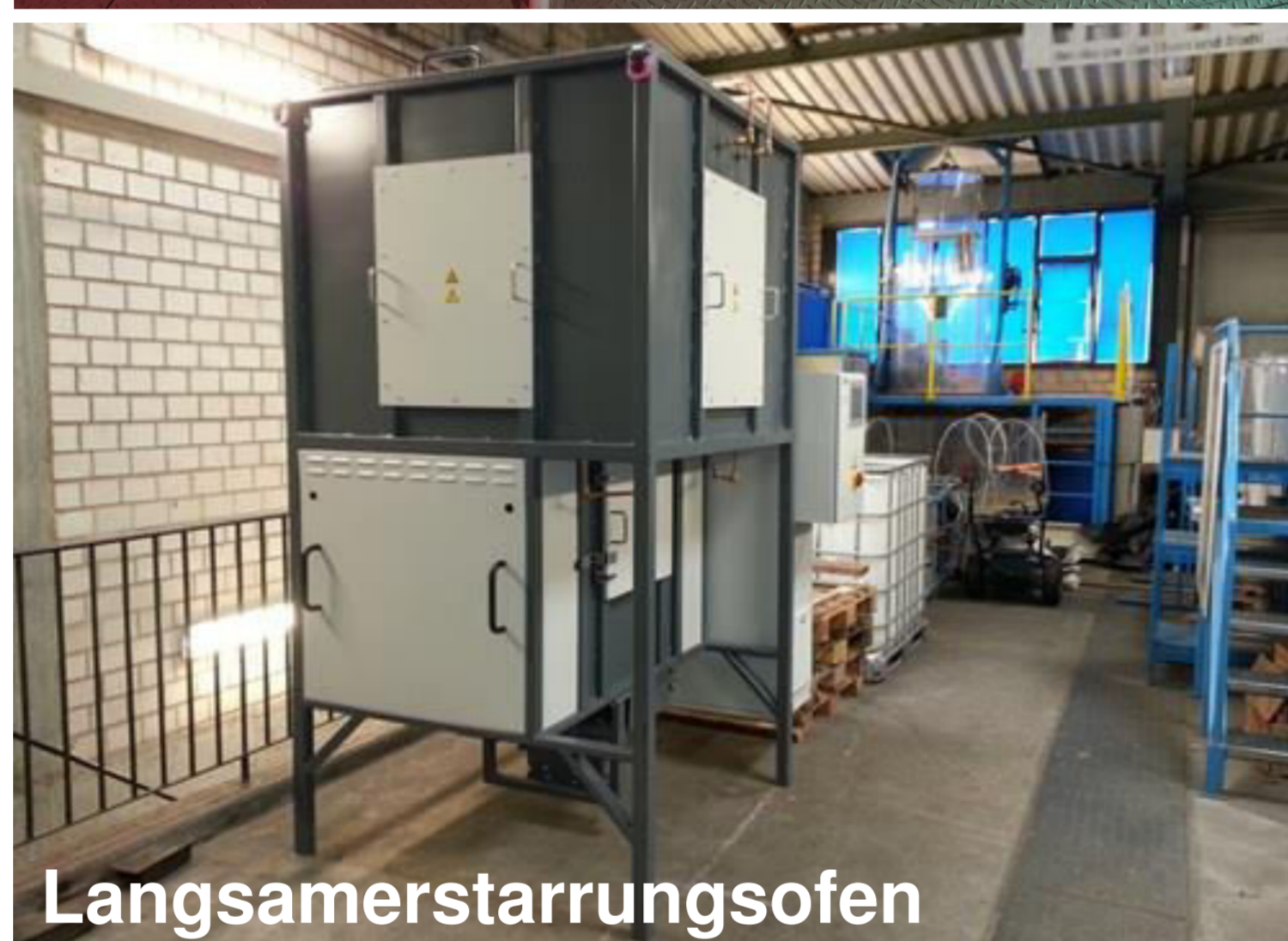
Oben: Vakuuminduktionsofen 4 (100 kg) Unten: Langsamerstarrungsofen
